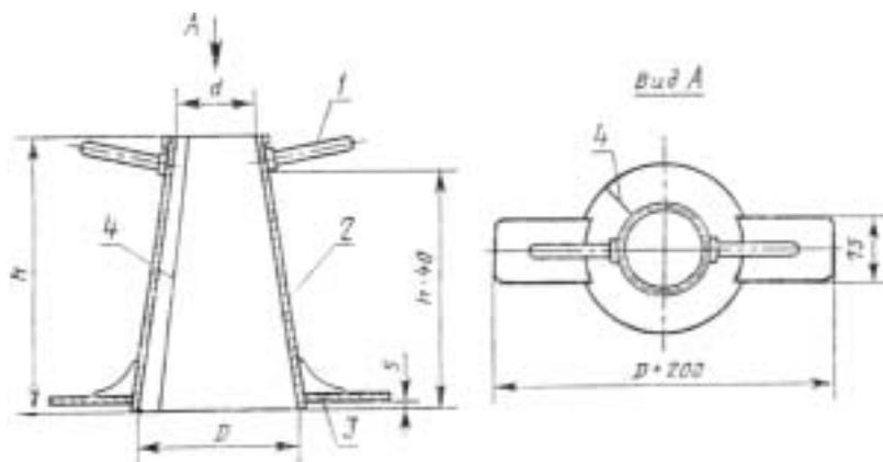
1 - ручка; 2 - корпус прибора; 3 - упоры; 4 - сварной шов
