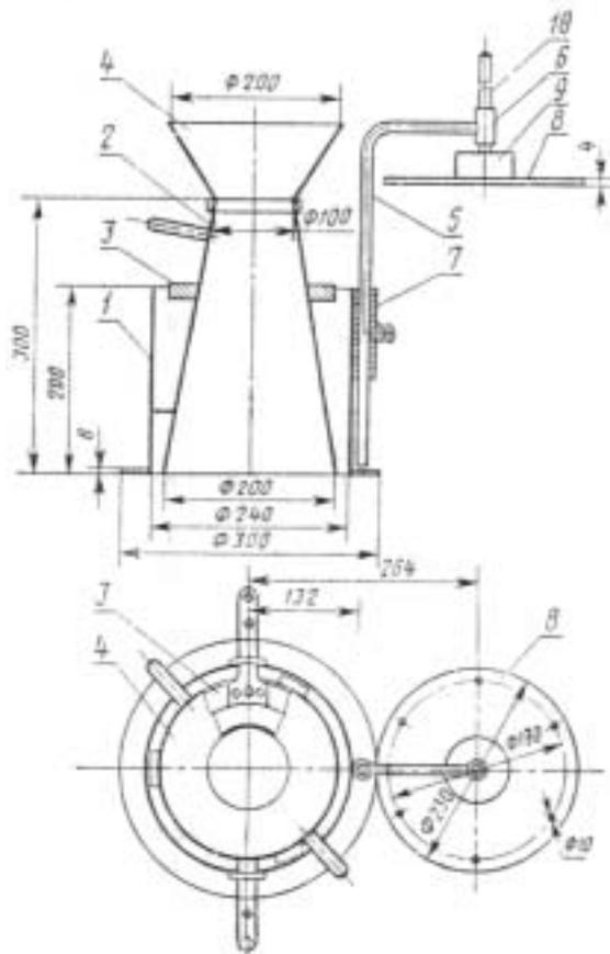
1 - цилиндрическое кольцо с фланцем в основании; 2 - конус; 3 - кольцо-держатель с ручками; 4 - загрузочная воронка; 5 - штатив; 6 - направляющая втулка; 7 - фиксирующая втулка с зажимным винтом; 8 - диск с шестью отверстиями; 9 - стальная шайба; 10 - штанга.
